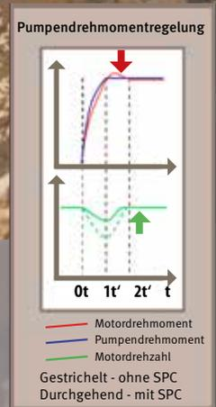
**SPC (Smart Power Control):** zwei Systeme (variable Drehzahlregelung und Pumpendrehmomentregelung), die zusammen den Wirkungsgrad erhöhen und dabei gleichzeitig die Produktivität aufrechterhalten.
