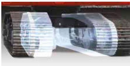
**Unterwagen erhältlich:** DX340LC-5-Unterwagen schmal/Standard: 3,00/3,28 m mit 600-mm-Stegen.
