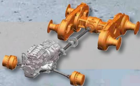
**Gesamtbetriebskosten:** Durch die Kombination der neuesten Scania Motoren mit ZF-Getrieben und unserer einzigartigen frei schwingenden Tandemhinterachse sind die Betriebskosten pro transportierte Tonne im Vergleich zu anderen Modellen auf dem Markt konkurrenzlos. Minimaler Kraftstoffverbrauch wird durch das sofortige Betätigen der Überbrückungskupplung erreicht, was Schlupf vermeidet und damit einen Leistungsabfall verhindert.
