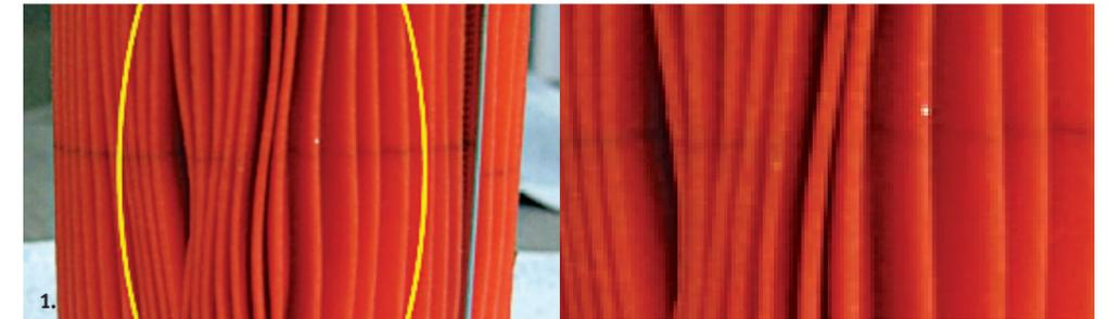
2. Una estructura interna con deficiencias de unión a causa de adhesivos de baja calidad hará que el filtro sea propenso a la separación de los elementos, lo que ocasionará daños importantes al filtro.
