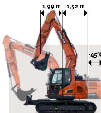
**Raggio di rotazione posteriore ridotto:** per agevolare l'uso della macchina in aree urbane e spazi angusti, il raggio di rotazione posteriore è del 45% inferiore e quello anteriore del 24% inferiore rispetto al modello convenzionale DX140LC-5. Il diametro minimo di rotazione è pari a soli 3,51 m.
