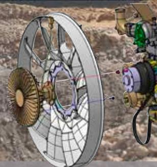
**Ventola viscostatica elettronica:** per garantire capacità di raffreddamento ottimali, la ventola è controllata elettronicamente tramite un mozzo viscostatico, che riduce la rumorosità e migliora l'efficienza dei consumi.
