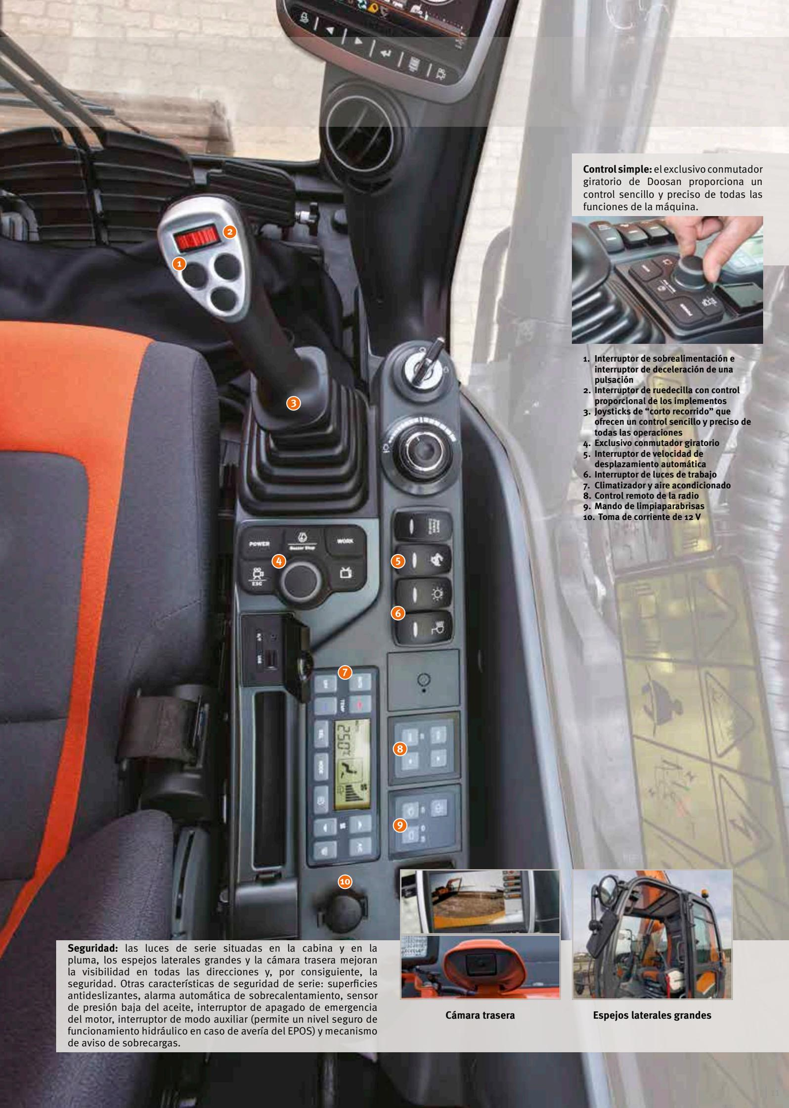
**Control simple:** el exclusivo conmutador giratorio de Doosan proporciona un control sencillo y preciso de todas las funciones de la máquina.
