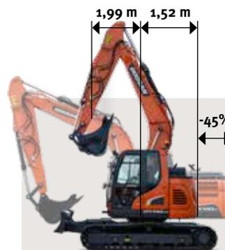
**Radio de giro de voladizo reducido:** para facilitar el uso en ciudad y en espacios estrechos, el radio de giro se ha reducido, un 45% en el voladizo y un 24% en la parte delantera con respecto a la DX140LC-5 convencional. Puede realizar giros con un diámetro de solo 3,51 m.
