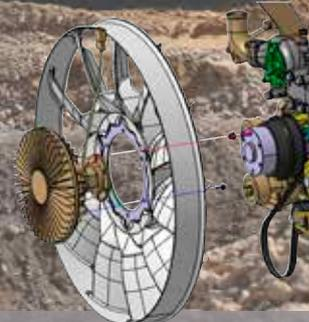
**Embrague viscoso del ventilador electrónico:** para una refrigeración óptima, la velocidad del ventilador está controlada electrónicamente por un embrague de ventilador que reduce el ruido del ventilador y logra un consumo más eficiente de combustible.
