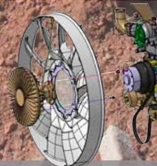
**Embrague viscoso eléctrico del ventilador:** para una refrigeración óptima, la velocidad del ventilador está controlada electrónicamente por un embrague de ventilador que reduce el ruido del ventilador y logra un consumo más eficiente de combustible.
