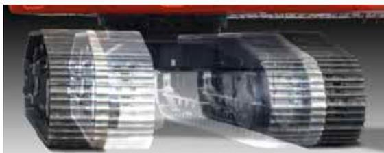
**Il sottocarro più largo sul mercato nella classe delle 50 t assicura a DX490LC-7 / DX530LC-7 una stabilità senza pari.**
