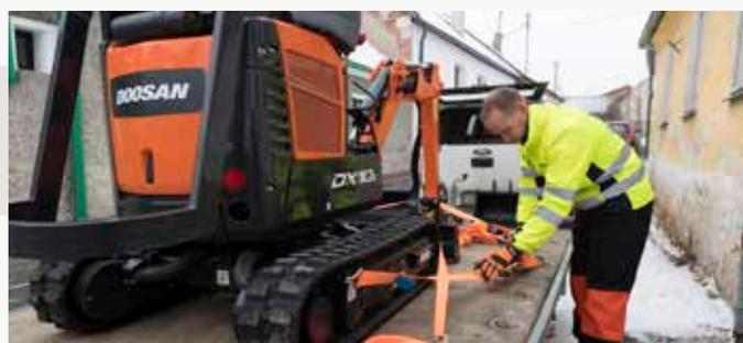
**Facilidad de transporte:** La DX10Z puede cargarse fácilmente en un remolque convencional. Mayor facilidad de transporte, con nuevos puntos de enganche integrados en la estructura superior.
