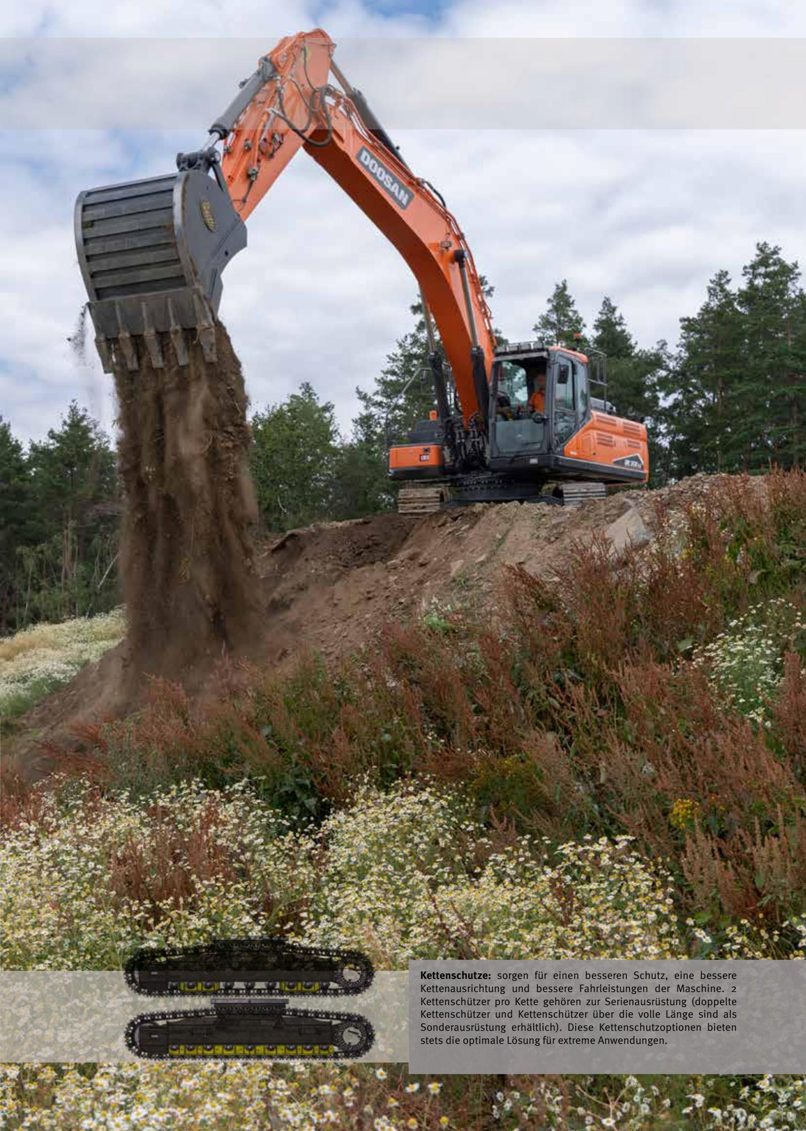
**Kettenschütze:** sorgen für einen besseren Schutz, eine bessere Kettenausrichtung und bessere Fahrleistungen der Maschine. 2 Kettenschützer pro Kette gehören zur Serienausrüstung (doppelte Kettenschützer und Kettenschützer über die volle Länge sind als Sonderausrüstung erhältlich). Diese Kettenschützooptionen bieten stets die optimale Lösung für extreme Anwendungen.
