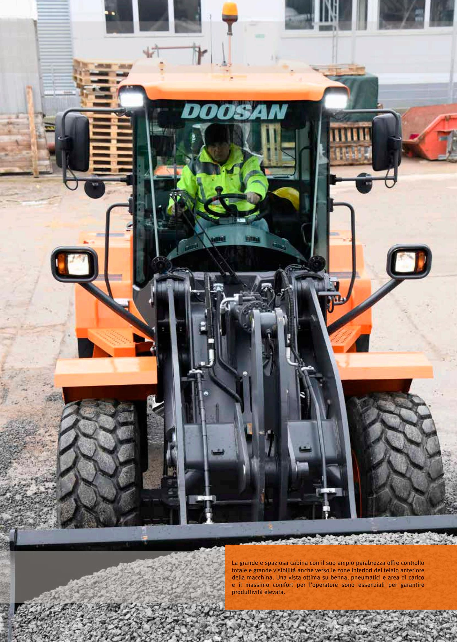
La grande e spaziosa cabina con il suo ampio parabrezza offre controllo totale e grande visibilità anche verso le zone inferiori del telaio anteriore della macchina. Una vista ottima su benna, pneumatici e area di carico e il massimo comfort per l'operatore sono essenziali per garantire produttività elevata.
