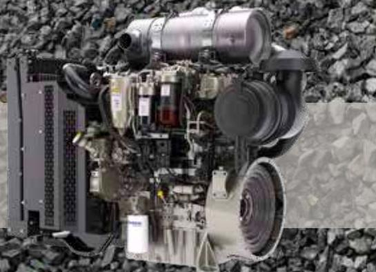
Il diesel con turbocompressore è pienamente conforme ai limiti sulle emissioni imposti dallo standard Stage IV. L'iniezione Common Rail rende più efficiente la combustione e migliora il rendimento economico in qualsiasi condizione di lavoro. L'assenza della rigenerazione DPF consente all'operatore di avviare e spegnere il motore anche per brevi utilizzi.
