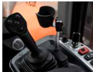
Joystick con leva per la 3<sup>a</sup> spola e selettore F/R
