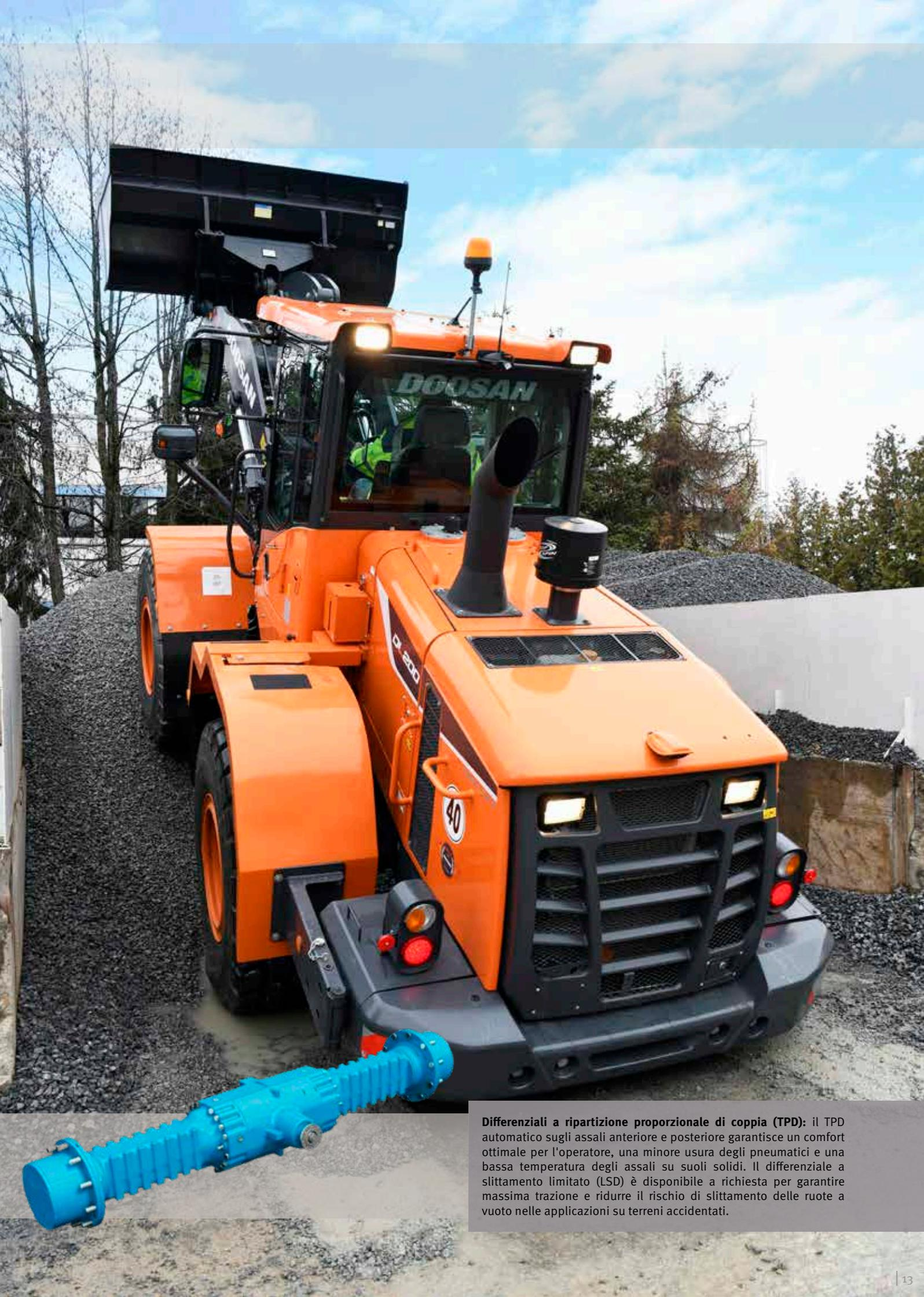
**Differenziali a ripartizione proporzionale di coppia (TPD):** il TPD automatico sugli assali anteriore e posteriore garantisce un comfort ottimale per l'operatore, una minore usura degli pneumatici e una bassa temperatura degli assali su suoli solidi. Il differenziale a slittamento limitato (LSD) è disponibile a richiesta per garantire massima trazione e ridurre il rischio di slittamento delle ruote a vuoto nelle applicazioni su terreni accidentati.
