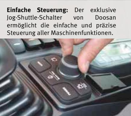
**Einfache Steuerung:** Der exklusive Jog-Shuttle-Schalter von Doosan ermöglicht die einfache und präzise Steuerung aller Maschinenfunktionen.
