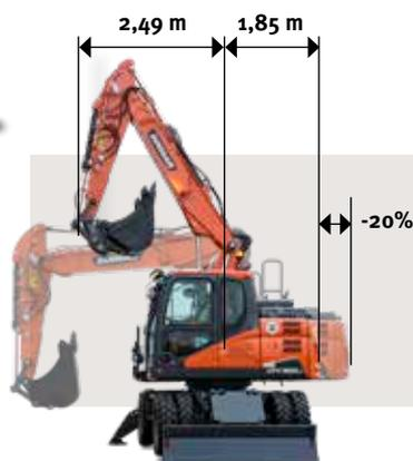
**Raggio di rotazione posteriore ridotto:** per agevolare l'uso della macchina in aree urbane e spazi angusti, il raggio di rotazione posteriore è del 20% inferiore. Il diametro minimo di rotazione è pari a soli 4,5 m.
