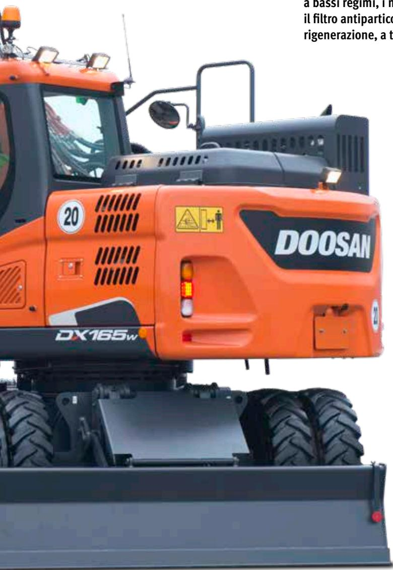
☉ **Telaio resistente:** telaio di chassis e stabilizzatori rinforzati per ridurre le sollecitazioni e migliorarne la durata.
