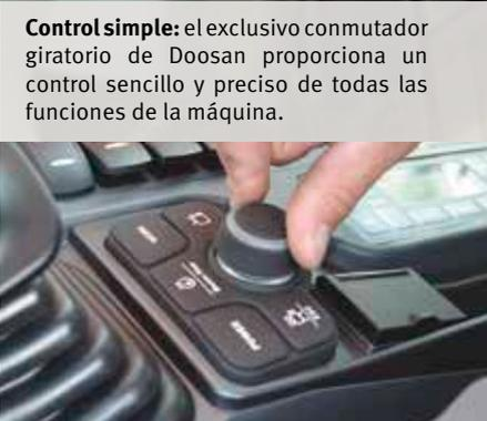
**Control simple:** el exclusivo conmutador giratorio de Doosan proporciona un control sencillo y preciso de todas las funciones de la máquina.
