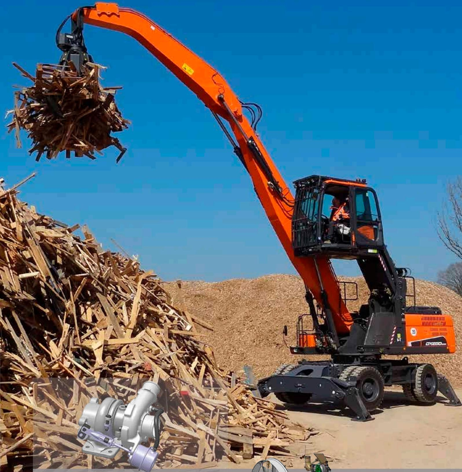
**Turbocompresor con válvula de descarga:** desvía los gases de escape de la turbina para regular mejor la presión máxima de sobrealimentación y proteger el motor. También disminuye el tiempo que pasa antes de que el turbo comience a girar/generar fuerza que maximice el par y además reduce el desgaste en condiciones de régimen elevado y baja carga. El turbocompresor aumenta la densidad del aire, lo que permite al motor producir más potencia sin que influya mucho la altitud.
