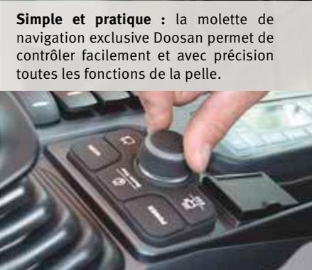
**Simple et pratique :** la molette de navigation exclusive Doosan permet de contrôler facilement et avec précision toutes les fonctions de la pelle.
