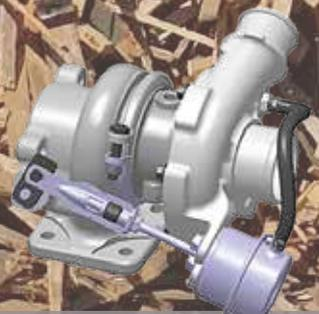
**Turbolader mit Ladedruck-Regelventil:** Leitet Abgase vom Turbinenrad weg, um den Ladedruck optimal zu regeln und den Motor zu schützen. So kann der Turbolader schneller das maximale Drehmoment erzeugen und unterliegt bei hohen Drehzahlen und geringer Belastung einem geringeren Verschleiß. Turbolader erhöhen die Luftdichte, so dass der Motor ungeachtet der Standorthöhe (ü. NN.) mehr Leistung erzeugt.
