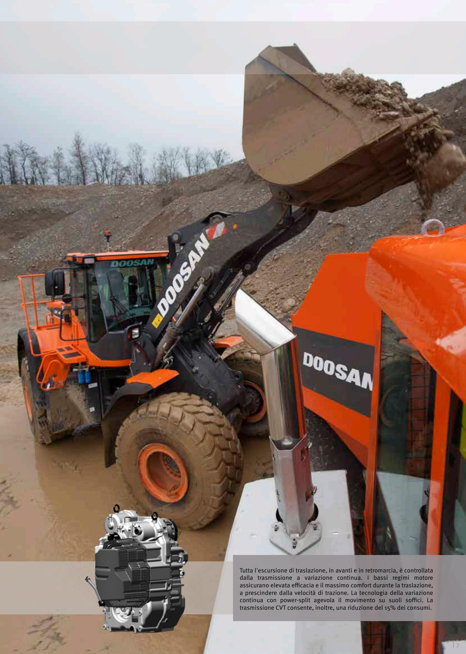
Tutta l'escursione di traslazione, in avanti e in retromarcia, è controllata dalla trasmissione a variazione continua. I bassi regimi motore assicurano elevata efficacia e il massimo comfort durante la traslazione, a prescindere dalla velocità di trazione. La tecnologia della variazione continua con power-split agevola il movimento su suoli soffici. La trasmissione CVT consente, inoltre, una riduzione del 15% dei consumi.
