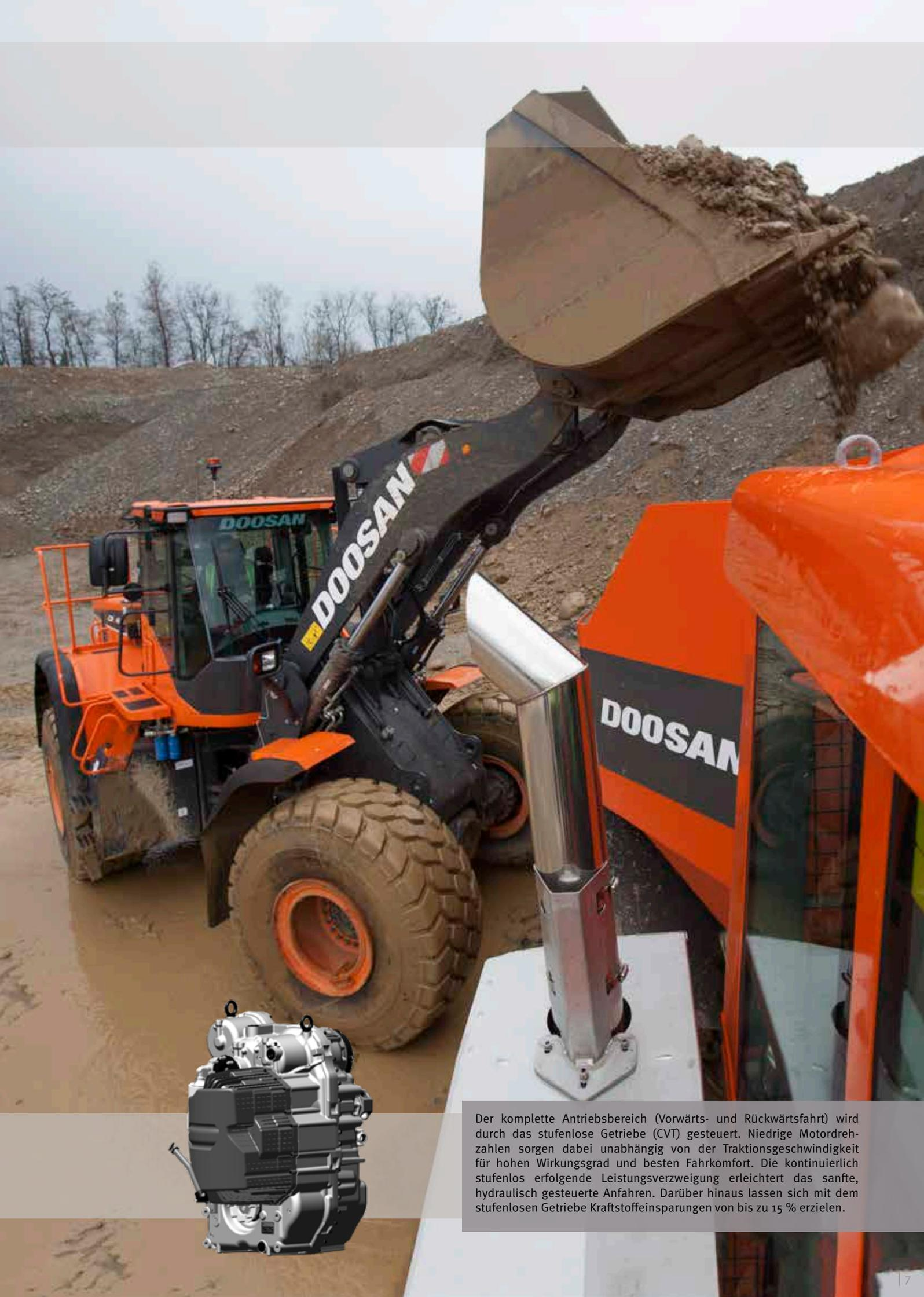
Der komplette Antriebsbereich (Vorwärts- und Rückwärtsfahrt) wird durch das stufenlose Getriebe (CVT) gesteuert. Niedrige Motordrehzahlen sorgen dabei unabhängig von der Traktionsgeschwindigkeit für hohen Wirkungsgrad und besten Fahrkomfort. Die kontinuierlich stufenlos erfolgende Leistungsverzweigung erleichtert das sanfte, hydraulisch gesteuerte Anfahren. Darüber hinaus lassen sich mit dem stufenlosen Getriebe Kraftstoffeinsparungen von bis zu 15 % erzielen.
